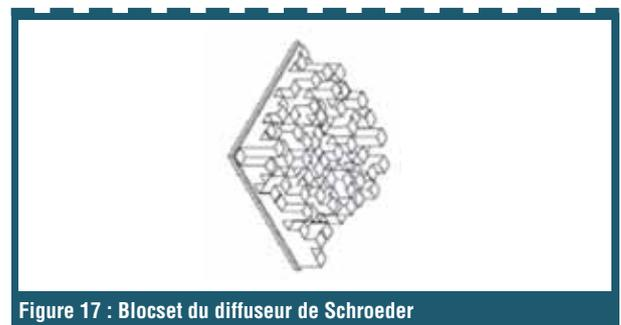
Figure 17 : Blocset du diffuseur de Schroeder
